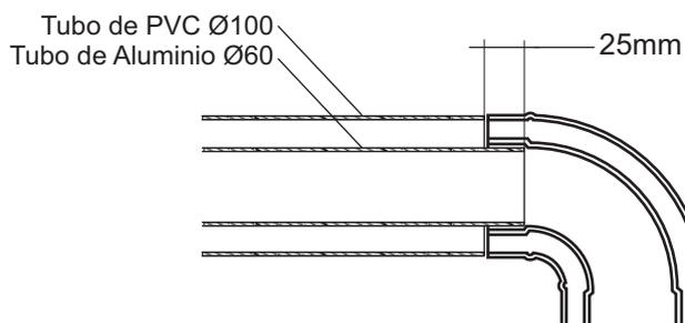
La instalación de la salida de humos para un sistema concéntrico contempla un codo con brida de 90°, un máximo de 6 metros de conducto y un sombrerete terminal. Cada codo de 90° adicional equivale a una reducción de longitud del conducto de 1,30 mts.
