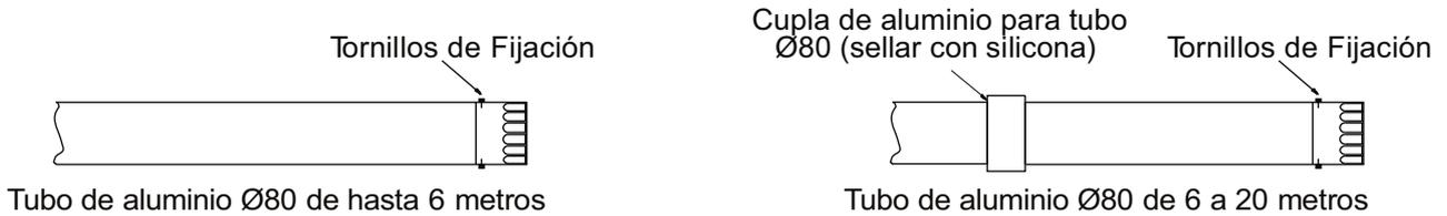
La instalación de la salida de humos para un sistema de conductos separados contempla un codo de 90°, los tubos de expulsión de gases (Ø80) y de aspiración de aire (Ø80) y el sombrerete terminal. Los conductos pueden ser de hasta un máximo de 20 mts cada uno o su equivalente (cada codo de 90° adicional equivale a una reducción de longitud del conducto de 1,30 metros).
